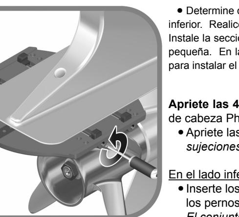
**Nota:** Las contratueras con inserto de nylon y las almohadillas adhesivas han sido diseñadas para ser usadas una sola vez solamente.
